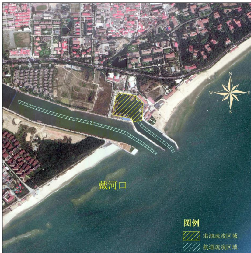
图 2.2-2 航道及港池疏浚工程平面布置图
