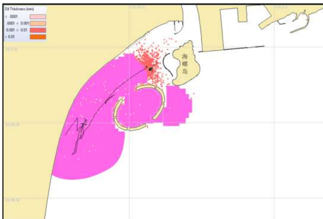
图 7.1-4 冬季常风条件下溢油 72h 油膜漂移位置及影响范围（落潮期）
