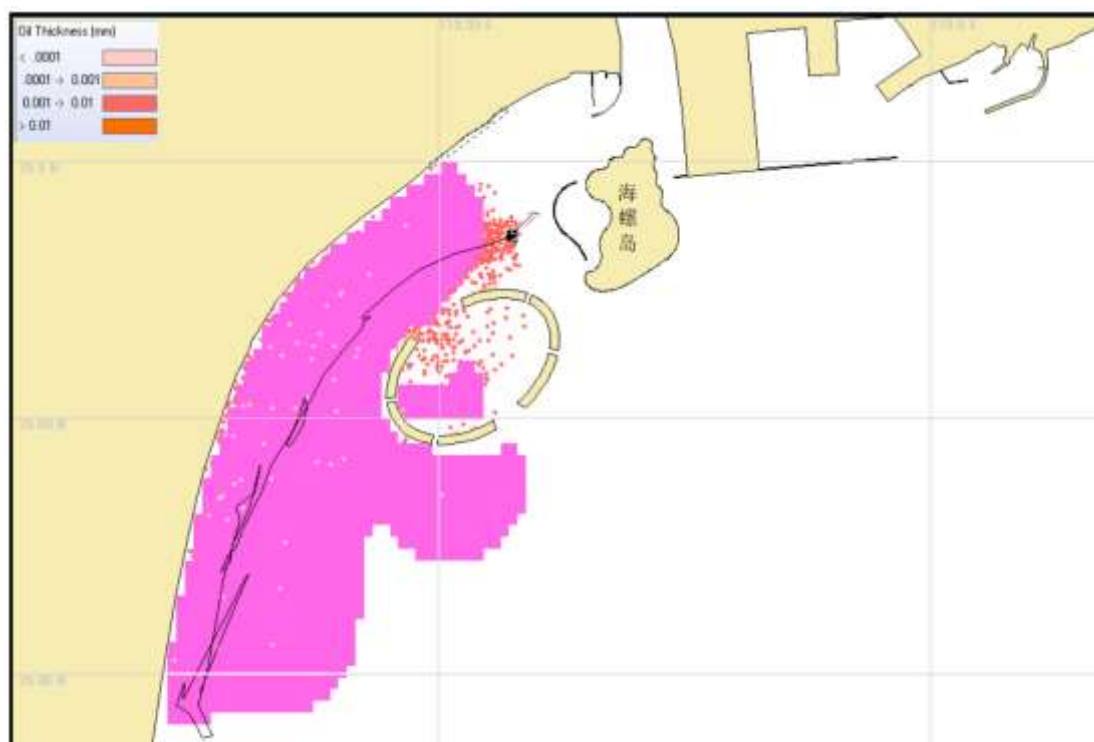
图 7.1-3 冬季常风条件下溢油 72h 油膜漂移位置及影响范围（涨潮期）
