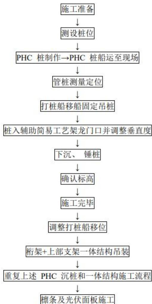
图 2.3-2 PHC 桩基础主要流程图
