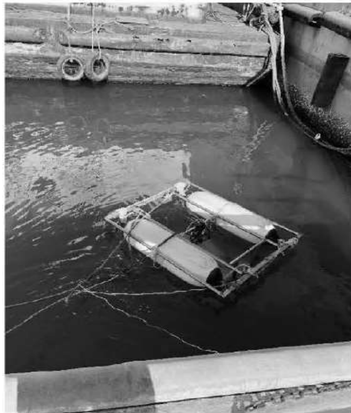
图 7 海上浅地层地质勘测
